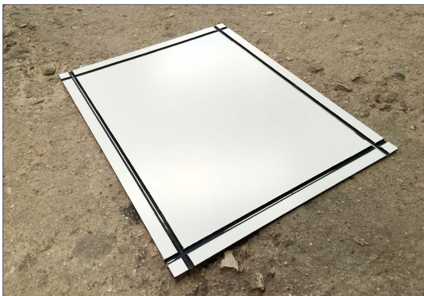
Figura 107: Lámina de composite para señal de aviso y peligro
