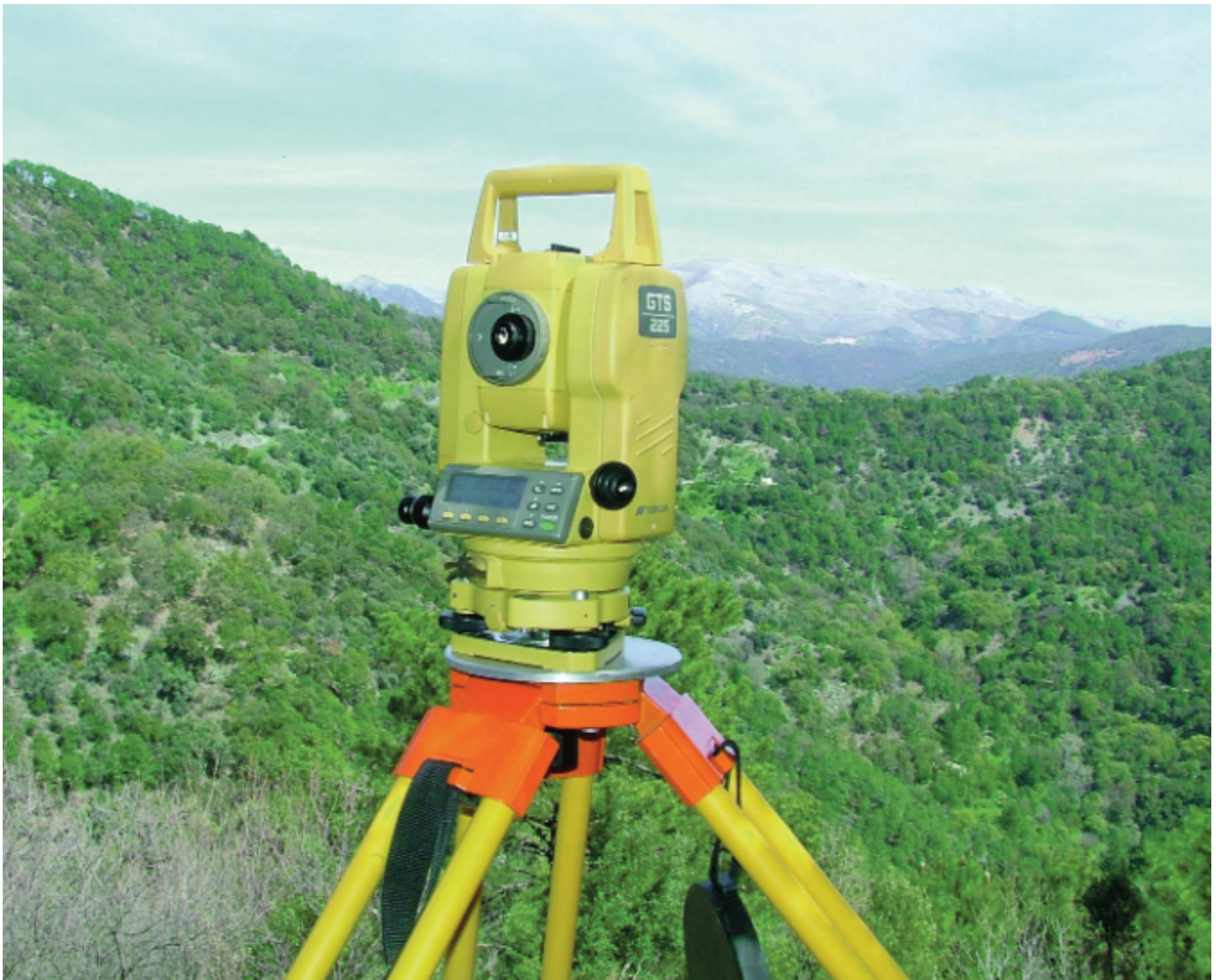
Estación total con distanciómetro láser para mediciones topográficas
