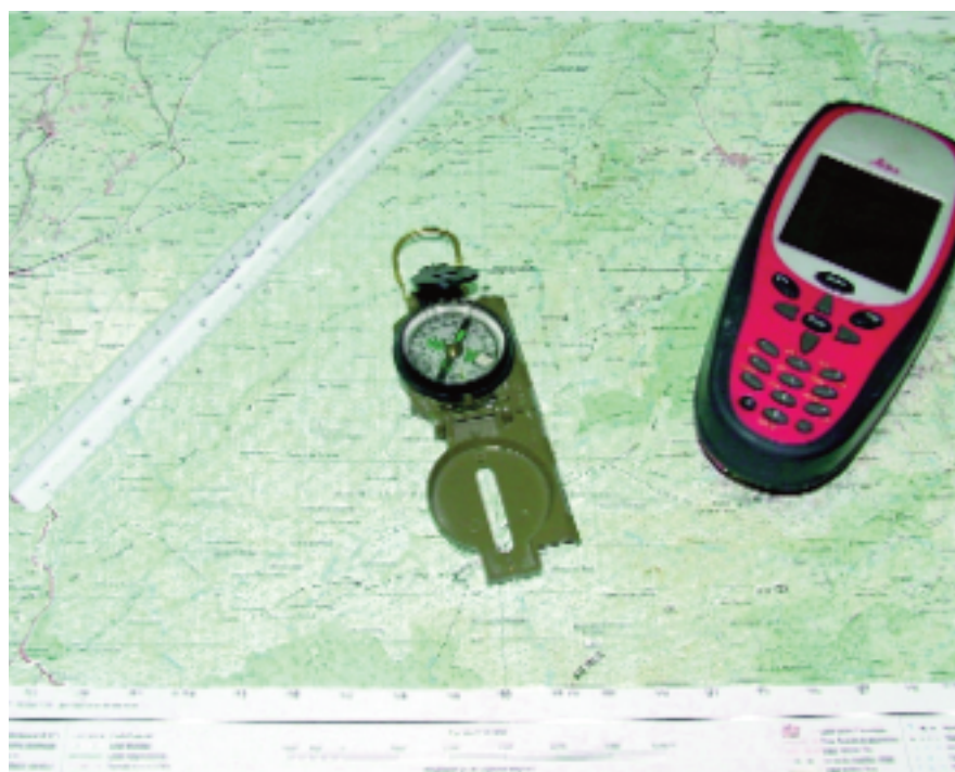
Instrumentos topográficos: escalímetro, brújula y GPS
