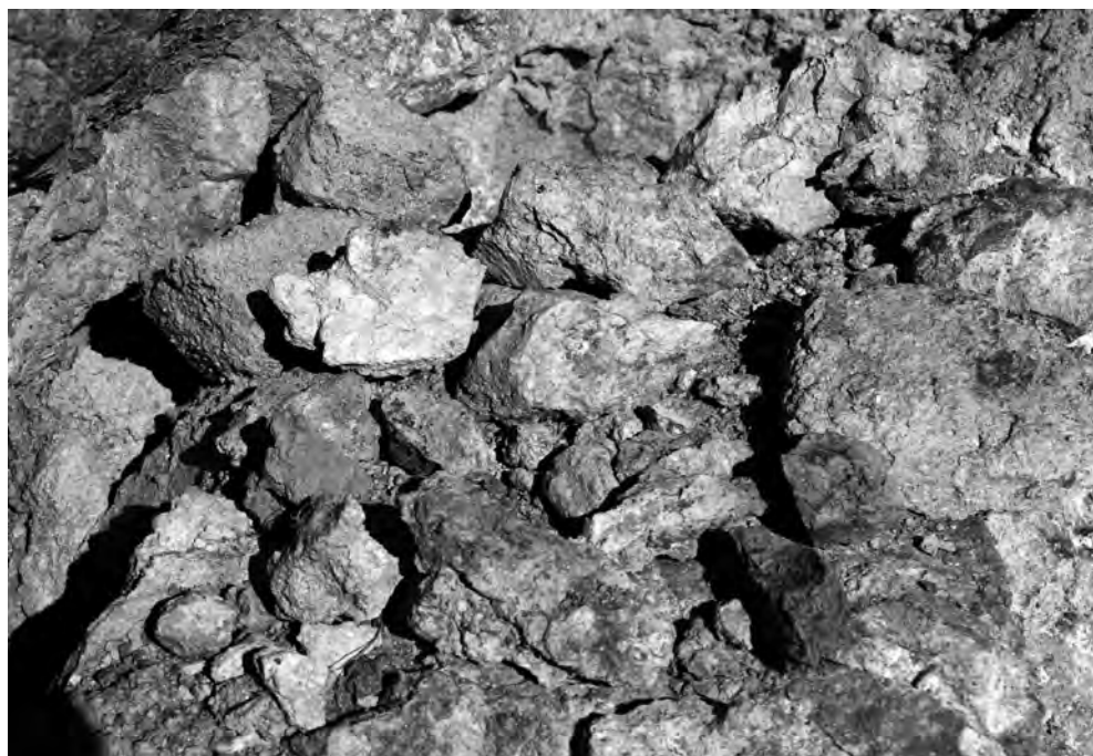
Figura 8. Masas terrosas de malaquita y azurita en la zona de enriquecimiento del yacimiento
