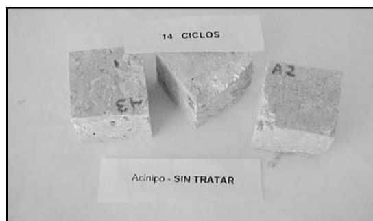
Fig.11. Probetas sin tratar tras 14 ciclos del ensayo de cristalización de sales
