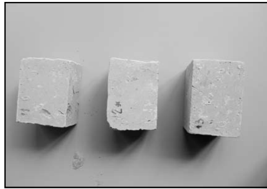
Fig. 29. Probetas Protector SX-12. 5 ciclos. Pequeñas desconchaduras
