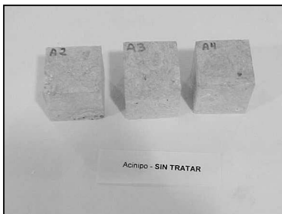
Fig.10. Probetas sin tratar antes del ensayo de cristalización de sales
