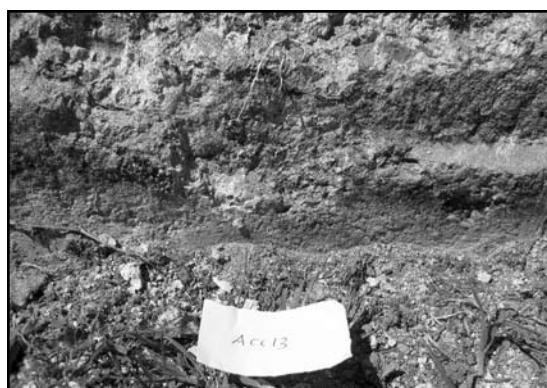
Fig. 17. Extracción de la muestra ACC-13, parte externa revestimientos
