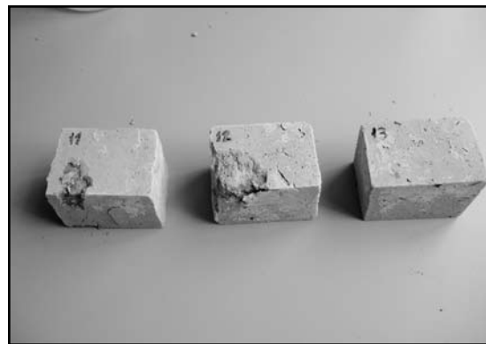
Fig. 30. Probetas Protector SX-12. Final del ensayo. 7 ciclos
