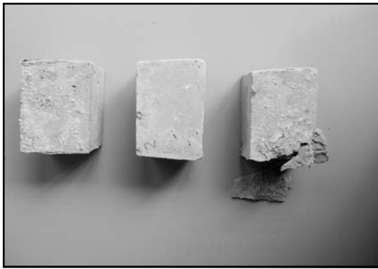
Fig. 27. Probetas tratadas con Silo 111. Final ensayo. Desconchaduras
