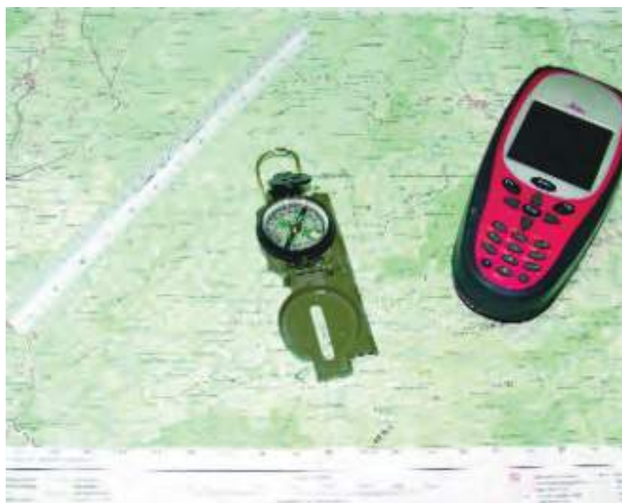
Instrumentos topográficos: escalímetro, brújula y GPS
